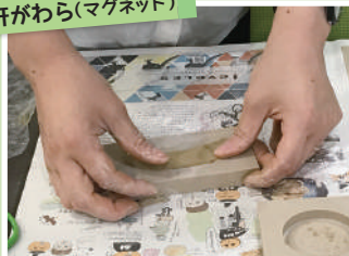
こねた粘土を型へ隙間が出来ないように、しっかり詰め込みます。
